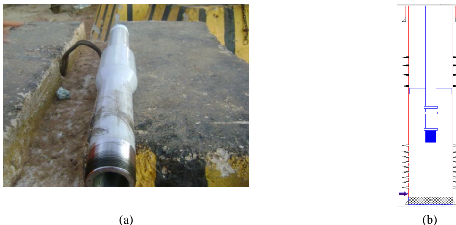
Figura 3 – (a) Dispositivo Magnético descido no SE-54 e (b) esquemático do poço (Petrobras, 2013).
